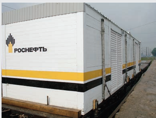
На железнодорожной платформе устанавливается 2 модуля. Груз тщательно закрепляют
